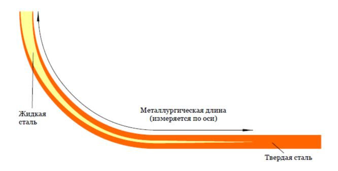
Металлургическая длина — это комплексная функция химического состава стали, скорости разливки, скорости охлаждения и размеров непрерывной заготовки, расчет которой не предусмотрен в данной модели. Для принятия разумных решений в отношении выбираемых параметров разливки пользуйтесь таблицами ниже.
