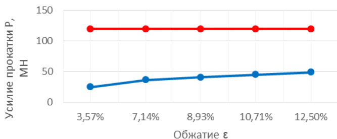
Рисунок 1. График зависимости усилия прокатки от обжатия при прокатке полосы 280 мм
