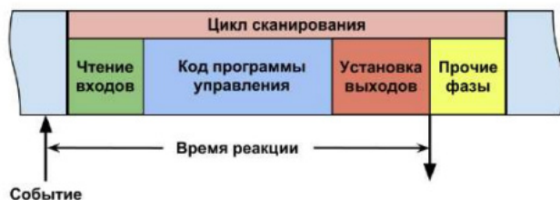
Рисунок 2. Рабочий цикл ПЛК
