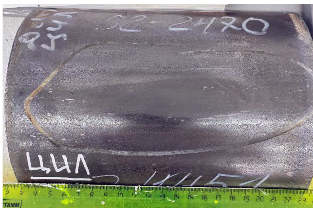
Рисунок 1. Типичный внешний вид невыформованного участка на наружной поверхности исследуемой трубы группы прочности K55 типоразмером \text{Æ}168,28 \times 7,32 мм
