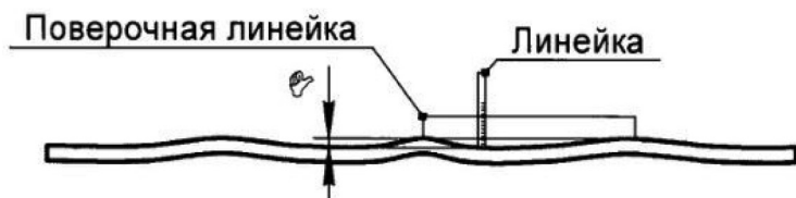
Рисунок 3. Контроль локального отклонения от плоскостности
