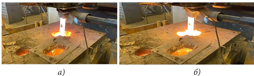
Рисунок 1. Момент визуального определения шлаковых частиц на поверхности металла в промежуточном ковше: а) до появления ковшового шлака; б) признаки появления ковшового шлака на поверхности жидкой стали
