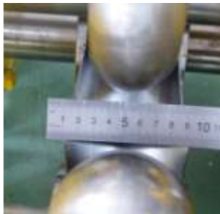
Рисунок 6 – Замер распушивания меж двух клетей в процессе формовки
