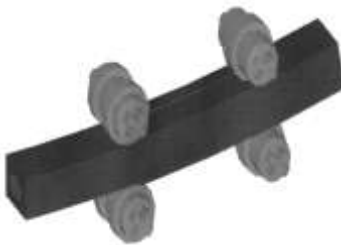
Рисунок - 1 Схема расположения валков при «двухстадийном» «мягкого» обжатии
