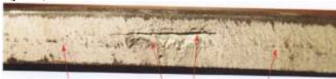
Рис.1. Внутренняя трещина в слябе
