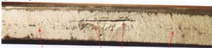
Рисунок - 1 Внутренняя трещина в слябе
