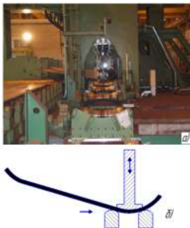
Рисунок 2 – Первая операция гибки: а) Пресс шагового формоизменения; б) Схематичный процесс первой операции гибки на прессе шагового формоизменения
