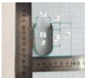
Рисунок 6 - U-образная заготовка: а) исходное положение заготовки и рабочего инструмента; б) U-образная заготовка после снятия нагрузки
