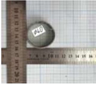
Рисунок 8 - «О» - Трубная заготовка без зазора между кромками после процесса О.Ф.
