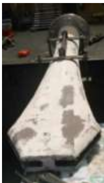
Рисунок - 1 Двухпортовый погружной разливочный стакан
