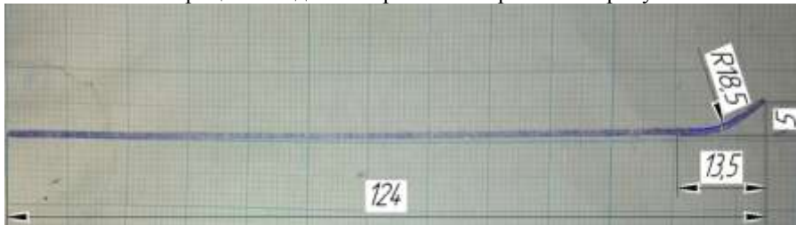
Рисунок 9 - Геометрические параметры кромки после снятия нагрузки эксперимент
