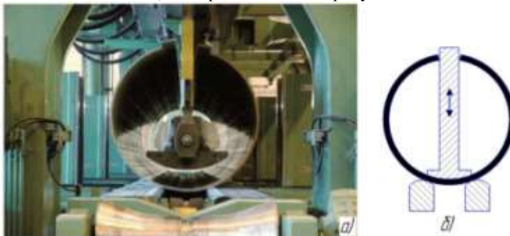
Рисунок 4 – Последняя операция гибки: а) Последний шаг гибки б) Схематичный процесс завершения процесса шагового формоизменения (получение трубы «О» - образного профиля с разомкнутыми кромками)
