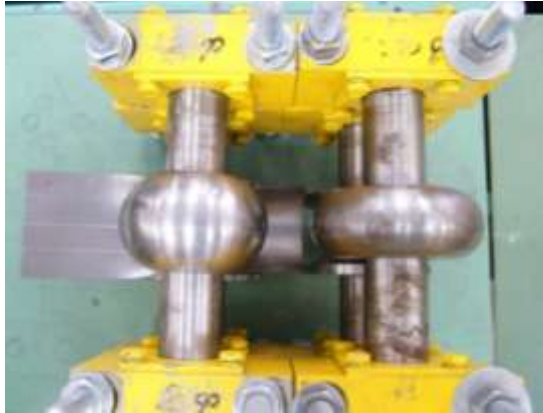
Рисунок 5 – Деформирование заготовок в двух открытых калибрах одновременно
