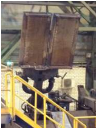
Рисунок 8 – Установка интенсивного охлаждения (UFS) полосы стана 1950 ЛПК
