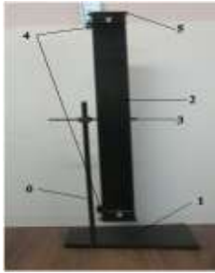
Рисунок 1 – Устройство для определения прочности при ударе: 1-подставка, 2-емкость, в которую падают окатыши, 3- ось вращения емкости, 4- заслонки, 5- крышка емкости с замком, 6-стойка, на которой крепится ось
