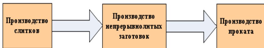
Рис. 2. Усовершенствованная схема производства стали
