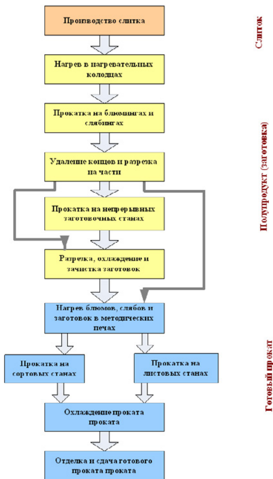
Рис. 3. Последовательность производства проката из обычного слитка
