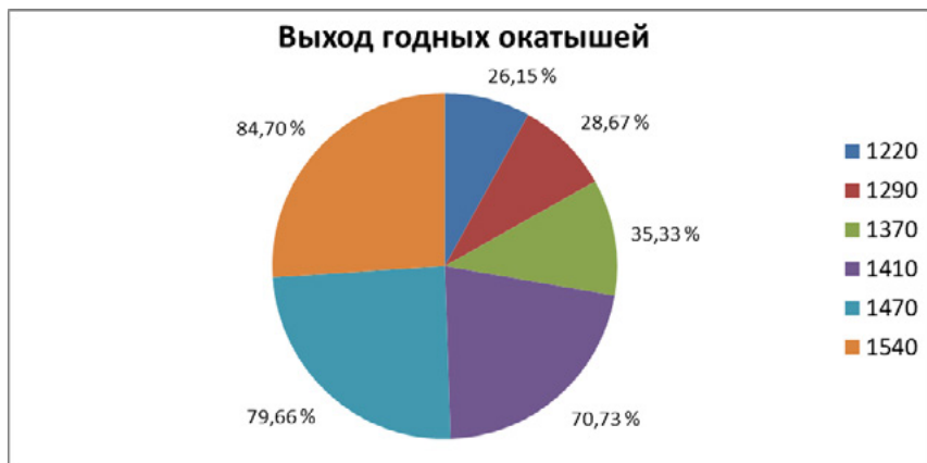
Рисунок 3. Зависимость выхода годного класса от удельной поверхности
