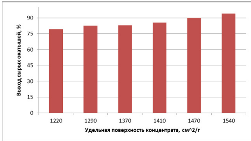
Рисунок 2. Зависимость выхода сырых окатышей от удельной поверхности
