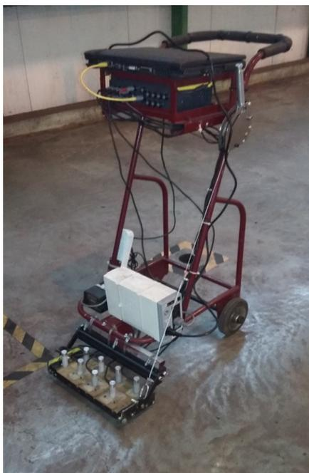
*Рисунок 2. Механизированная восьмиканальная установка вихретокового контроля для поиска зон с повышенной твердостью на базе ВД-91НМ*
