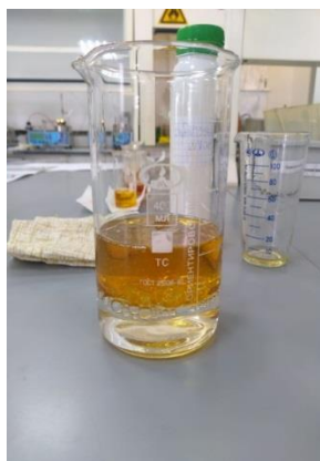
Рис. 1. Эмульсия «вода - топливное масло» после механического перемешивания
