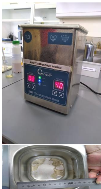
Рис. 3. Эмульсия «вода – топливное масло» после использования ультразвука в течение 2 мин при температуре 20 градусов по Цельсию
