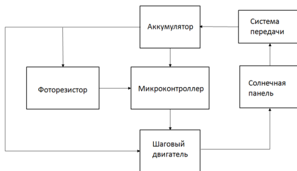
Рис. 1. Функциональная схема системы ориентации батареи
