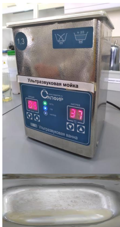
Рис.к 4. Эмульсия «вода – топливное масло» после использования ультразвука в течение 5 минут при температуре 37 градусов по Цельсию
